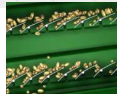
Alsó+felső rosta zár
