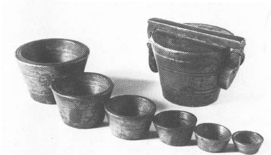
Lat (lót): 6 darabból álló sárgaréz mérőszerszám, egymásba illeszthető, zárható fedéllel.
