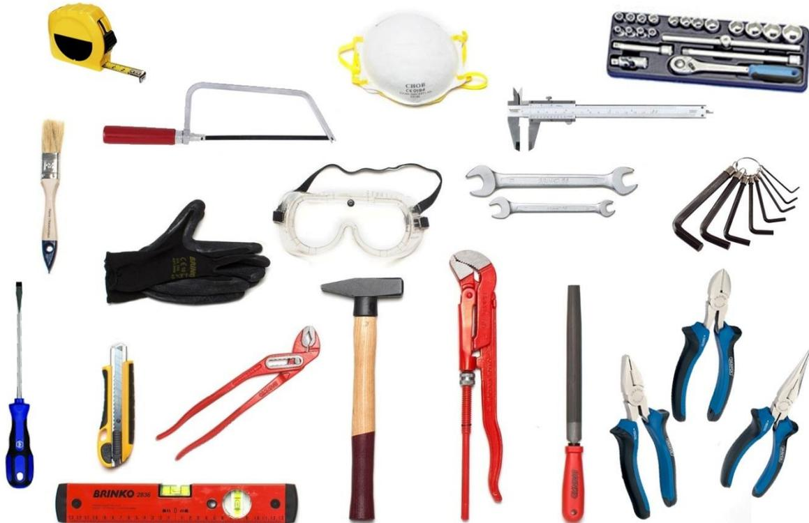
Multimeter, Säge, Schutzmaske, Schlüsselset, Pinsel, Schutzhandschuh, Schutzbrille, Schieblehre, Schraubenschlüssel, Imbusschlüssel, Schraubendreher, Schneider, Rohrzanze,
