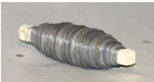
82. ábra A tekercsdrót vágásához is a csípőfogó használata ajánlott, a metszőollót ne használjuk erre!
