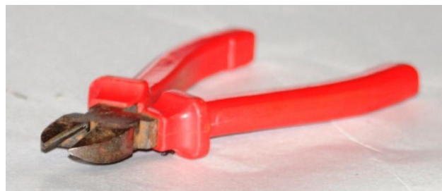
82. ábra A tekercsdrót vágásához is a csípőfogó használata ajánlott, a metszőollót ne használjuk erre!
