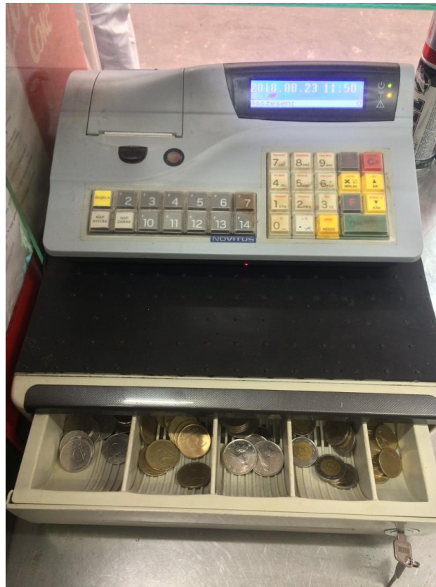
152. ábra Jól láthatók a pénztárgép részei, a kijelzők, a billentyűzet, a fiók és a nyomdaszerkezet.
