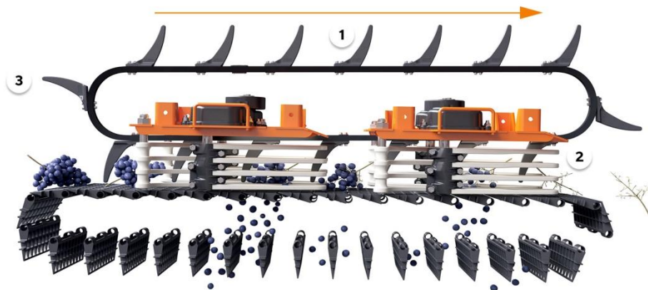
32. ábra: Lineáris bogyózó (1: Szőlő haladási iránya, 2: Bogyózást végző rázóujjak, 3. Szőlőt továbbító szerkezet)
