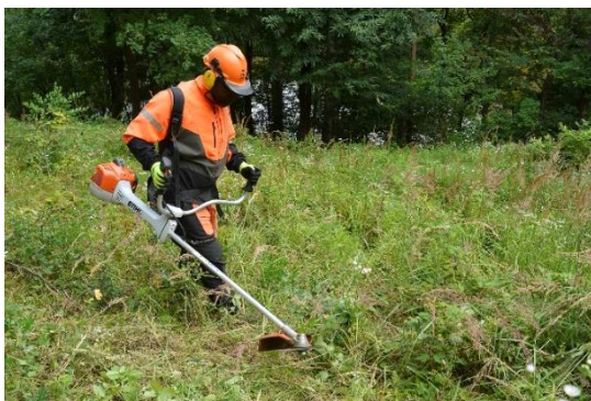
47.2. Az adapteres tisztítófűrész az erdősítések ápolásának gyakori eszköze
