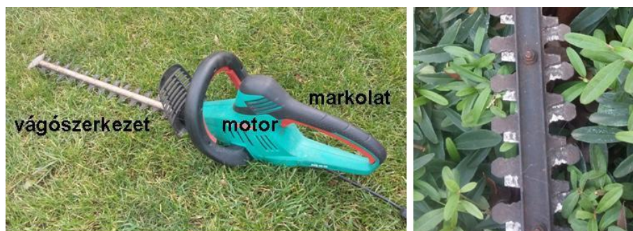
291. ábra A sövénynyírógép szerkezeti egységei a vágószerkezet, a motor és a markolat. A vágószerkezet két, egymáson elmozduló pengesorból áll.
