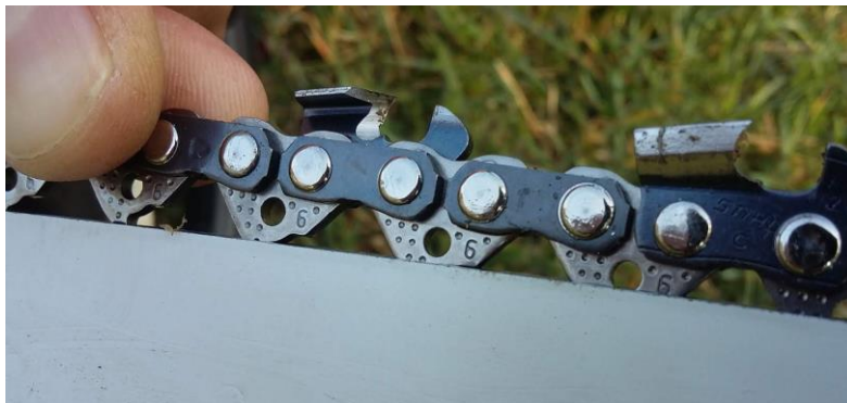
290. ábra A láncfeszesség ellenőrzése: a feszesség akkor megfelelő, ha a lánc 3-4 mm-re elhúzható a vezetőlemeztől.
