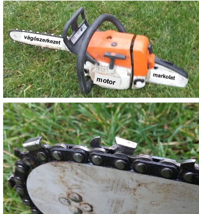
288. ábra A motorfűrész szerkezeti egységei a vágószerkezet, a motortömb és a markolat. A vágószerkezet a vezetőlemezen körkörösén futó gyalufogas fűrészláncból áll.
