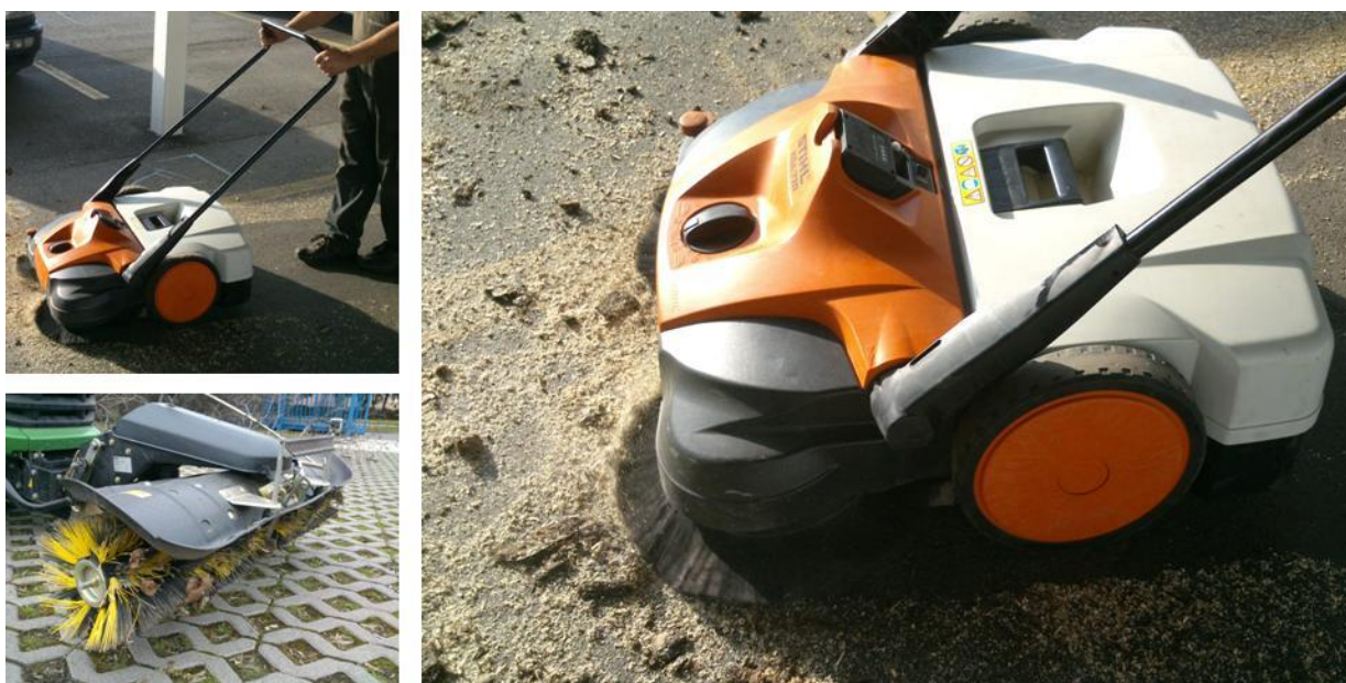
293. ábra A takarítógépek egyik típusa, amikor a talajon guruló gépet a kezelője mozgatja. Nagyobb felületen használhatók a kistraktorokra szerelt adapterek. A gépek legfontosabb szerkezeti eleme a kefehenger, ami a tartályba söpri az utca szemetét.
