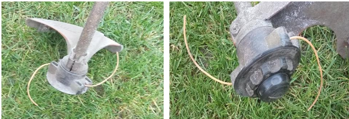
286. ábra A damilszálas fűkasza vágószerkezete a nagy sebességgel forgó műanyagszál. Ez tépi el a fűszálakat. A felverődések, sérülések megelőzésére védőborítás helyezkedik el a vágófej hátsó oldalán.
