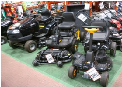
287. ábra A nagyobb fűfelületek fenntartását könnyítik meg a fűnyíró kistraktorok. Járószerkezetük pázsítkerekekkel van felszerelve. Ezek a kerekek nagy felületűek, barázdáik sekélyek, ezért a pázsitban sem tesznek kárt.
