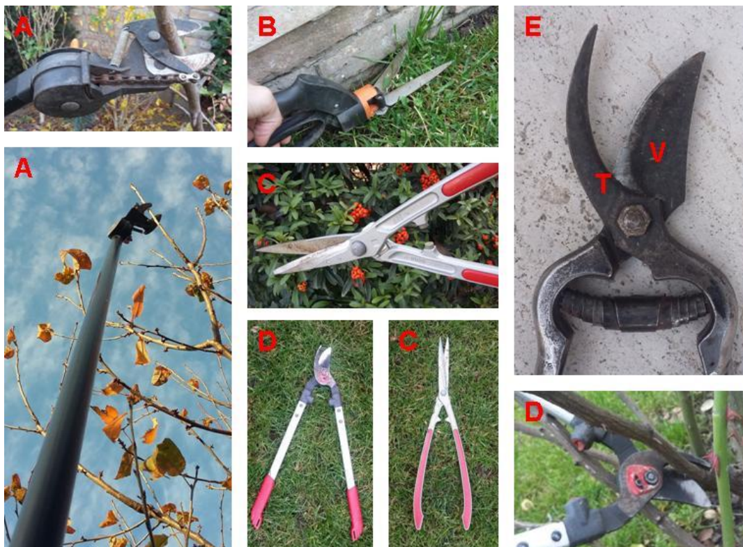
281. ábra Ollók: A: magassági ágvágó, B: fűnyíró olló, C: sövénynyíró olló, D: ágvágó vagy karos olló, E: metszőolló (T – támasztóél, V – vágóél).
