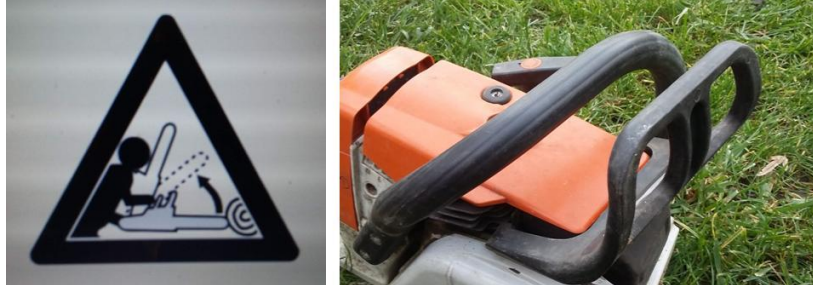
289. ábra A motorfűrész legfontosabb biztonságtechnikai berendezése a láncfék. A fűrész felcsapódásakor automatikusan bekapcsolódik, és a lánc egy pillanat alatt leáll.
