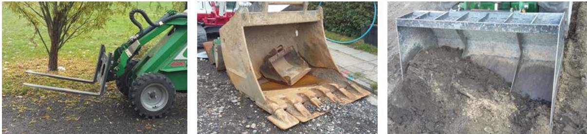
307. ábra A homlokrakodók emelővillája a raklapok mozgatására alkalmas, a zárt rakodó kanállal ömlesztett anyagokat, például termőföldet lehet a helyszínen szállítani vagy pakolni.
