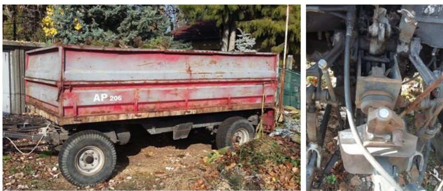
306. ábra A kéttengelyes pótkocsik nagy mennyiségű anyag szállítására alkalmasak. Mivel közúti forgalomban is részt vesznek, bonyolult rendszerrel kapcsolódnak az erőgépekhez (pl. fékkábel, világítás). A rögzítést csapszegkötés biztosítja.
