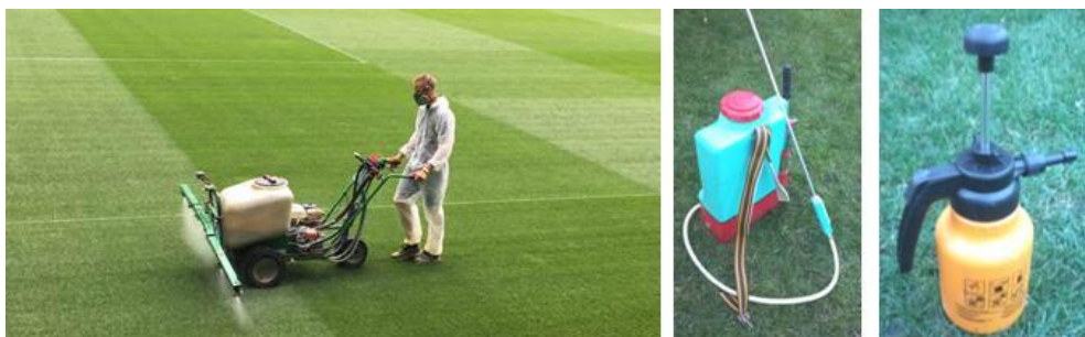
299. ábra Önjáró, háti és kézi működtetésű permetező gépek.
