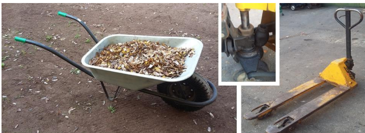
305. ábra A kézi anyagmozgatást leggyakrabban talicskával könnyítjük meg. Burkolatokon használható a kézi, hidraulikus raklapemelő (béka) is. Ezen a függőleges irányú emelést hidraulikus munkahenger végzi.
