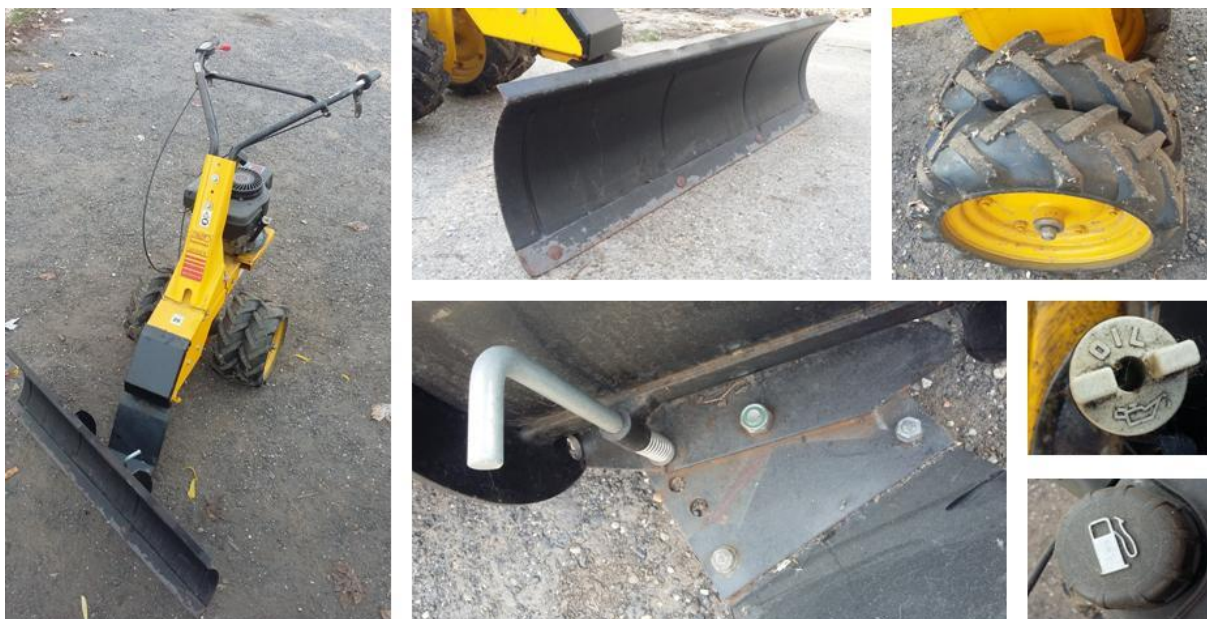
294. ábra A kistraktorra szerelt hókotró adapter ferde tolólapja a járda mellé csúsztatja ki az összegyűjtött havat. A tolólap ferdeségének szöge állítható. A járókerekek barázdái mélyek, hogy a gép a hóban ne csússzon meg. Üzemeltetés közben karbantartási feladat a motor kenő- és üzemanyagszintjének ellenőrzése és utántöltése.
