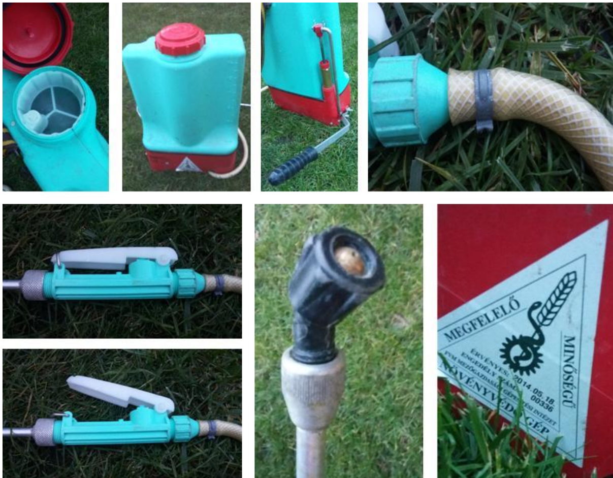
300. ábra A kézi működtetésű, háti permetező gép működése: a bekevert vegyszer a beöntőnyílás szűrőjén keresztül jut a tartályba, ahol a nyomókar segítségével túlnyomást idézünk elő (pumpálás). A nyomás a folyadékot a csővezetéken keresztül a nyitó/záró szerkezet szabályozásával a fúvókához viszi. Itt a folyadék cseppekre bomlik. Forgalomba hozni csak szabványos növényvédő gépeket szabad!
