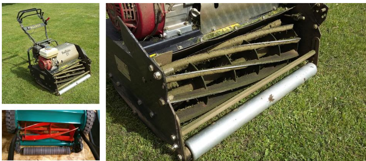
284. ábra A hengerkéses (vagy vágódobos) fűnyírók vágószerkezete a forgódobra felszerelt spirális késekből és rögzített ellenpengéből áll.
