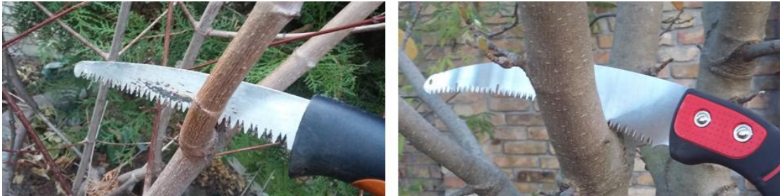
282. ábra Bicskafűrész és rókafarkú fűrész. Sűrű koronákban, szűk ágvillákban is használhatók. Az ívelt pengéjű változatokkal hatékonyabb, könnyebb a munka.
