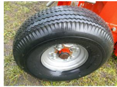
287. ábra A nagyobb fűfelületek fenntartását könnyítik meg a fűnyíró kistraktorok. Járószerkezetük pázsítkerekekkel van felszerelve. Ezek a kerekek nagy felületűek, barázdáik sekélyek, ezért a pázsitban sem tesznek kárt.
