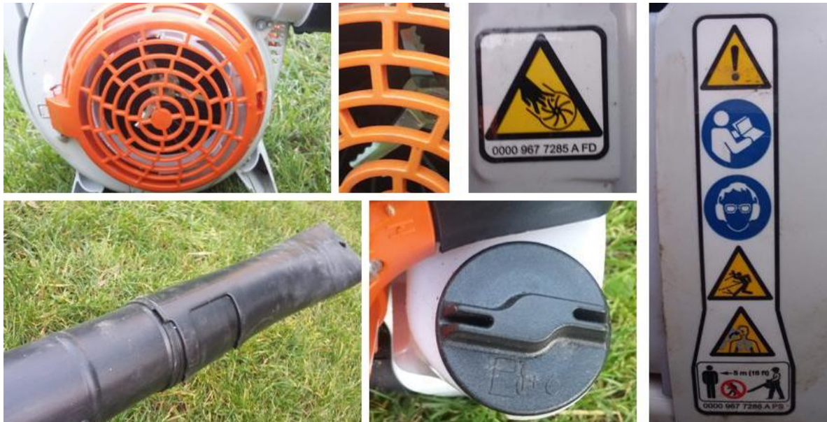
298. ábra A lombszívó-fújó gép működéséhez szükséges légáramlatot egy ventilátor biztosítja. Ennek fogazott, forgó lapátjai a leveleket is aprítják. Közelségük veszélyes, ezért a védőrácon benyúlni tilos. A légáramlatot egy cső segítségével lehet irányítani. A biztonsági előírások közül a védőtávolság, a fülvédő és a védőszemüveg a legfontosabbak. A karbantartás leggyakoribb lépése az üzem- és a kenőanyag keverékének utántöltése.
