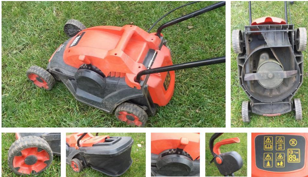
283. ábra A forgókéses fűnyírók központi szerkezeti eleme a védőborítással ellátott motor. A vágószerkezete egy függőleges tengelyre szerelt, két oldalán kiélezett kés. További egységei a járókerekek, a fűgyűjtő kosár, a magasságállító karok és az indító berendezés. A gépek biztonsági előírásai például a védőtávolságokra, a zajveszélyre és az esőben való munkavégzés veszélyeire hívják fel a figyelmet.
