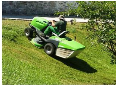
287. ábra A nagyobb fűfelületek fenntartását könnyítik meg a fűnyíró kistraktorok. Járószerkezetük pázsítkerekekkel van felszerelve. Ezek a kerekek nagy felületűek, barázdáik sekélyek, ezért a pázsitban sem tesznek kárt.
