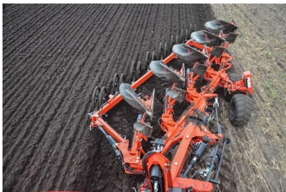
35. ábra: Ekére épített szántáselmunkáló
